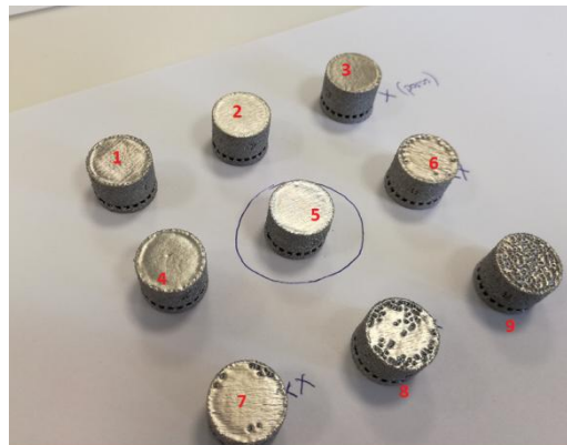
Ilustración 4. Piezas obtenidas con la variación de parámetros EBM en la aleación Ti6Al4V
