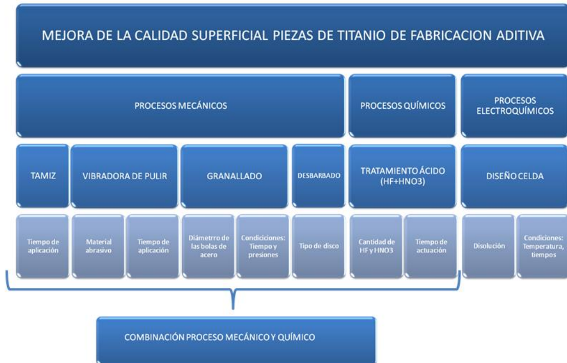
Ilustración 12. Plan de experimentos de post procesos para mejora de la calidad de piezas de titanio fabricadas con EBM
